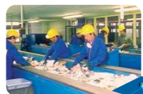
CENTRE DE TRI DE PLOUFRAGAN (SÉPARATION DU PLASTIQUE PAR COULEUR)
